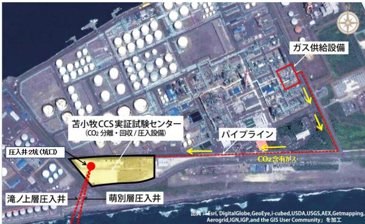
「ガス供給設備」は製油所の水素製造過程で生成されるPSAオフガス(CO<sub>2</sub>含有ガス)を、延長1.4kmのパイプラインで「分離・回収・圧入設備」に送るための設備です。
