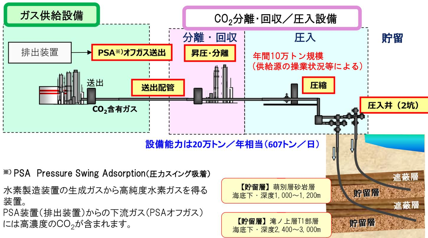
製油所の水素製造装置から生成される二酸化炭素(CO<sub>2</sub>)を含むガスから、CO<sub>2</sub>を分離・回収し、圧入に必要な圧力まで昇圧(最大23MPa)して、年間10万トン規模のCO<sub>2</sub>を苫小牧沖の2つの貯留層に圧入し、貯留します。
