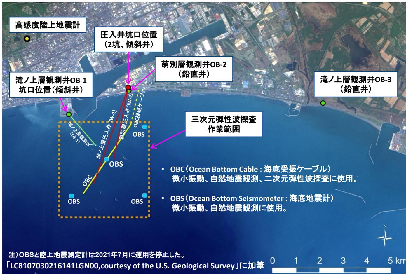
CO<sub>2</sub>圧入地点近傍および周辺に観測ネットワークを整備し、CO<sub>2</sub>圧入前(1年間)、CO<sub>2</sub>圧入中(3年間)および圧入終了後の6年間以上に亘って継続してモニタリングを行います。
