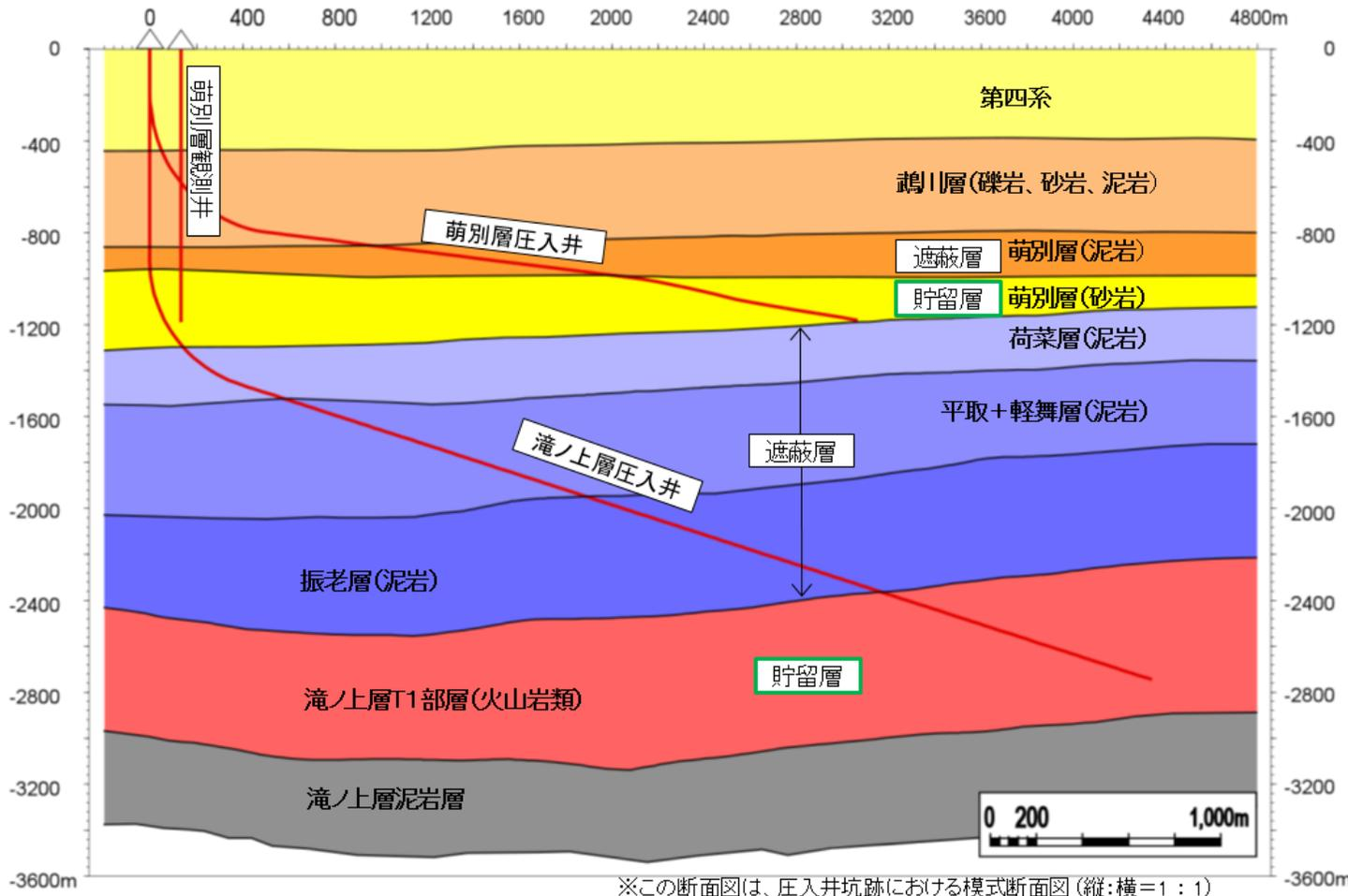
CO<sub>2</sub>貯留地点の地質断面図です。貯留層である滝ノ上層T1部層および萌別層砂岩層に2坑の圧入井によりCO<sub>2</sub>を圧入します。
